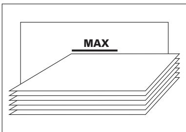
Bitte beachten Sie beim Einlegen der Folien in den Einzugschacht, dass Sie diesen nur bis zur Markierung des Seitenanschlages auffüllen.
